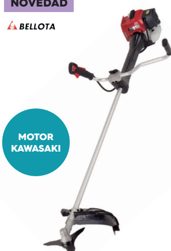
23023306 Motor de 2T de 45,3 cc, carburador Walbro. Barra de 28 mm. Cabezal con ancho de corte 46 cm semiautomático con hilo de 3,3 mm, cuchilla de corte de 305 mm, sistema antivibración.
