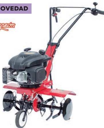
1010098 TM360. Motor de 4T de 2,5 Kw. Puede utilizarse a 36 cm de ancho con 2 juegos de fresas, a 60 cm de ancho con 3 juegos de fresas y a 64 cm con discos. Estructura compacta, fácil movimiento. Embrague correa.
