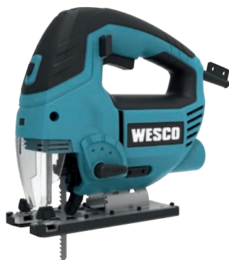
SIERRA DE CALAR 9716242 850W. Velocidad variable. Interruptor de bloqueo, luz LED. Interruptor soplador. Conexión para extracción de polvo externa. Placa base de aluminio, corte a inglete 45° ajustable. Ajuste de velocidad eléctrico. Potencia nominal: 850W. Velocidad sin carga: 0-3000/min. Longitud de carrera: 20 mm. Capacidad de bisel: 45° a la izquierda y derecha. Función de péndulo 4. Profundidad máx. de corte acero: 12 mm. Profundidad máx. de corte plástico: 15 mm. Profundidad máx. de corte en madera. 49'95
